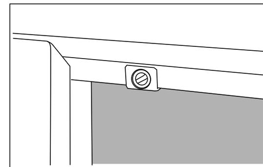
②マイナスドライバーを使ってマグネットを回し、前後位置を調整することができます。回す方向は、時計回りで奥方向に、反時計回りで手前方向に調整できます。
